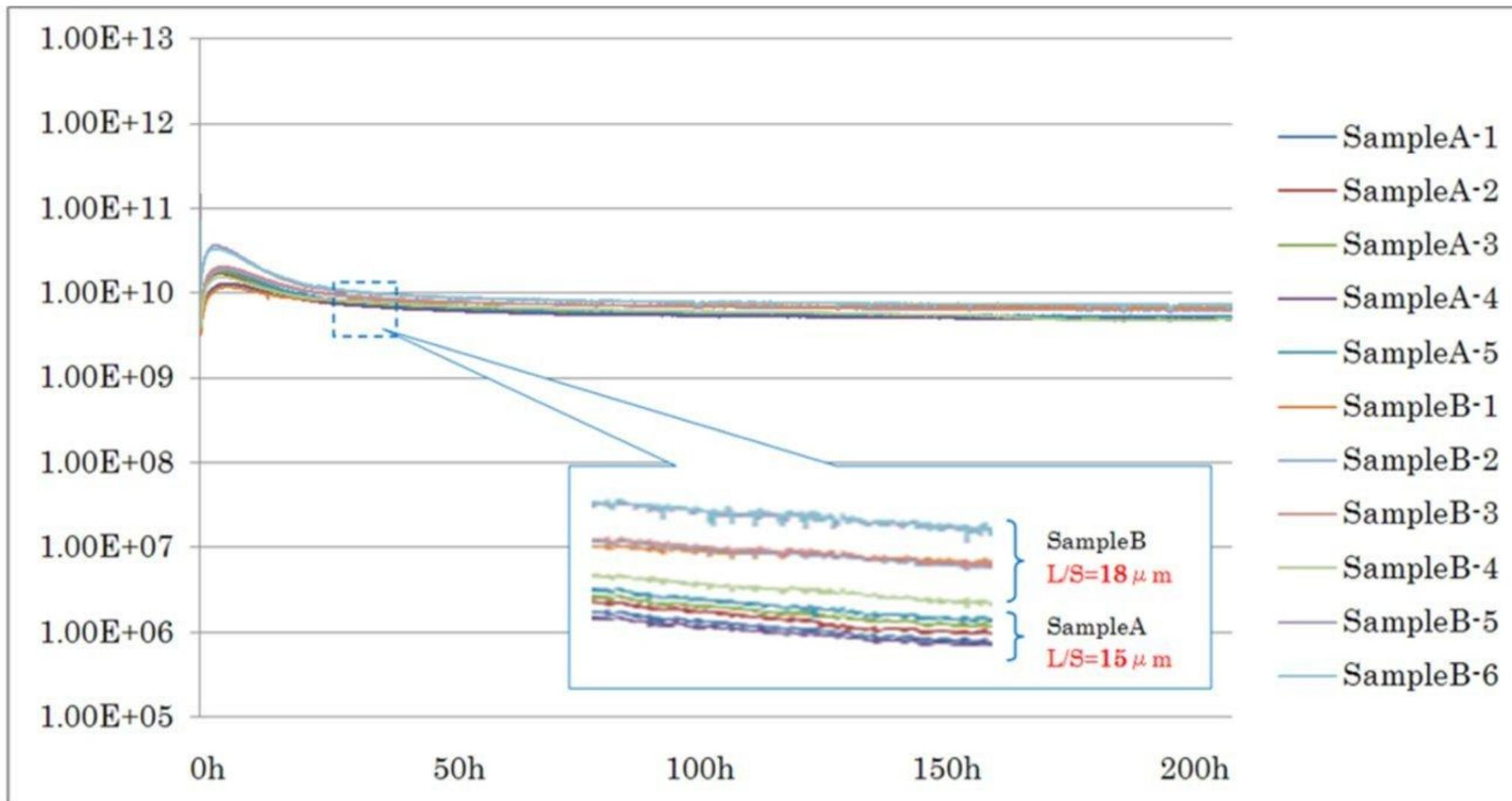
僅か  $3\mu\text{m}$  の L/S の差による抵抗値の違い(電流換算で約 100pA)も正確に計測します。
